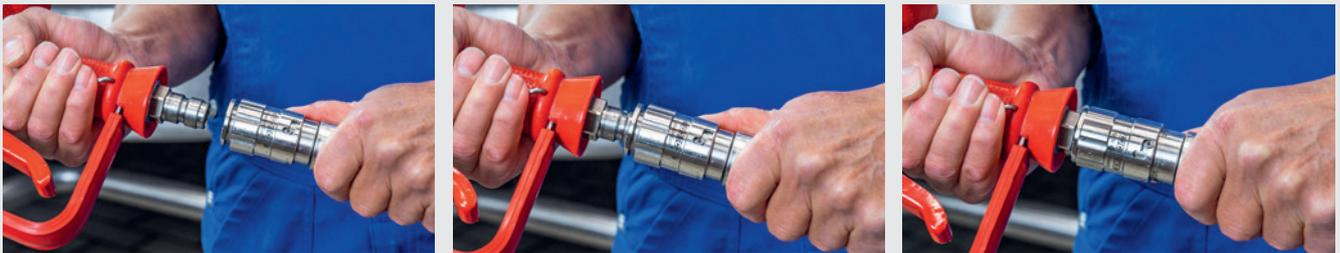
Zur Verbindung die Sicherheitskupplung und den Stecknippel zusammenführen. Die Verriegelungshülse der Kupplung rastet aufgrund der automatischen Sicherheitsverriegelung mit einer Verdrehung von selbst nach vorn in die endgültige Sicherungsposition ein. Die Kupplung ist nun fest mit dem Stecknippel verbunden und gegen unbeabsichtigtes Öffnen gesichert.
