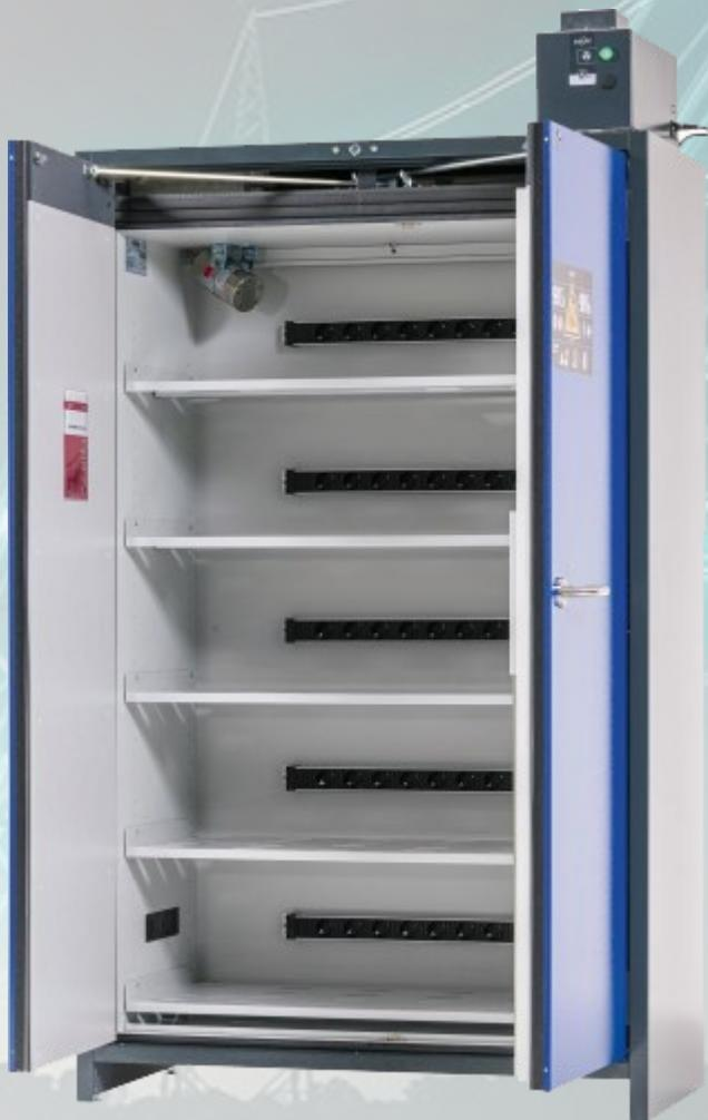
Geeignet zur sicheren passiven und aktiven Lagerung von Lithium-Ionen-Akkus in Arbeitsräumen. Feuerwiderstandsfähigkeit: 90 Minuten (typgeprüft gemäß DIN EN 14470-1) und 90 Minuten (typgeprüft in Anlehnung an DIN EN 1363-1, Brandeinwirkung von innen nach außen)
