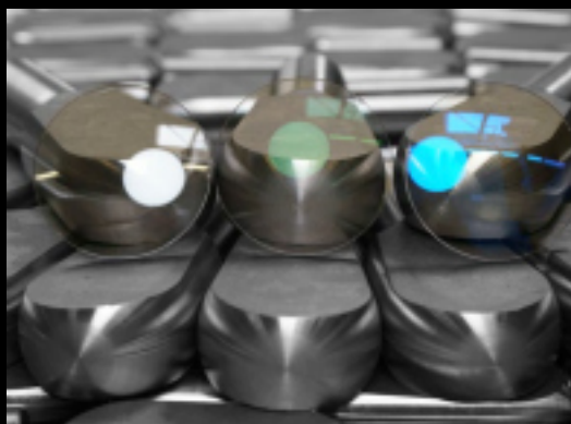
Brillenglas mit Hartschicht (links)/ohne Hartschicht rechts
