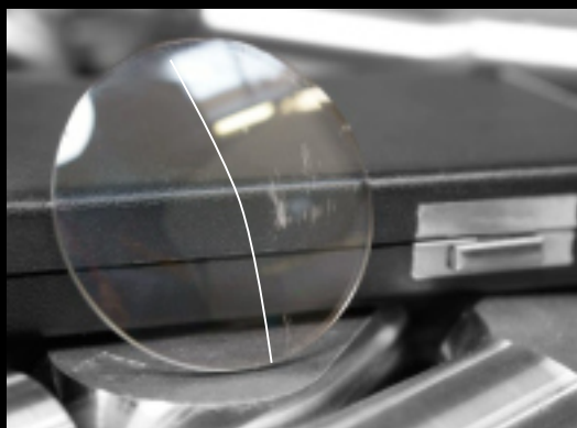
Brillenglas mit Hartschicht (links)/ohne Hartschicht rechts
