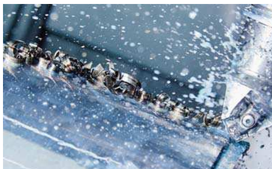
Dank seiner Formulierung auf Wasserbasis sorgt der KSS ‚Aquaslide‘ dafür, dass Oberflächen von Werkstücken oder zu entsorgende Späne frei von Fett und Verunreinigungen bleiben. Bild: polsterpics.com
